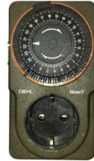
Ein nicht zu unterschätzende Intervention: die gute, alte (und günstige) Zeitschaltuhr
