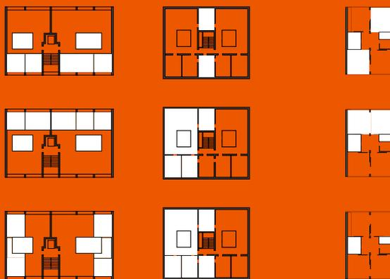
Bei zentraler Positionierung der Sanitärräume können die einzelnen Zimmer unterschiedlich angeordnet werden. Dadurch entsteht ein hohes Maß an Planungsflexibilität.<sup>15</sup>
