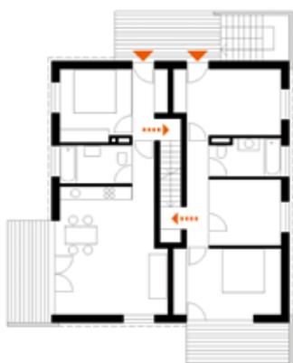
Die 50-m<sup>2</sup>-Einheiten werden durch die Innentreppe mit der darunter oder der darüber liegenden Wohnung verbunden.
